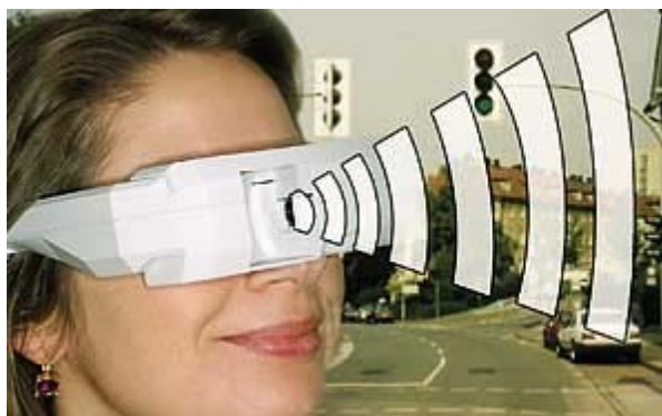
Blinden hilft diese "Ultraschall Orientierungsbrille" der Uni Greifswald mittels akustischer Signale beim Orten von Gegenständen. Foto: Uni Greifswald, Augenklinik
